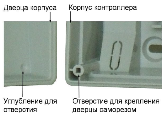
Рисунок 4. Схема «жесткого» крепления дверцы к корпусу контроллера
