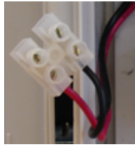
Рисунок 10. Клеммы для подключения замка к блоку питания
