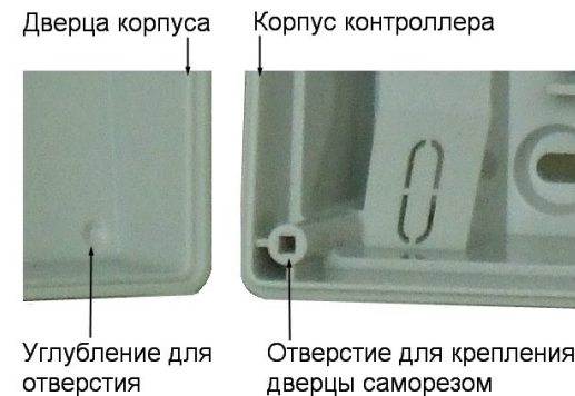
Рисунок 5. Схема «жесткого» крепления дверцы к корпусу контроллера
