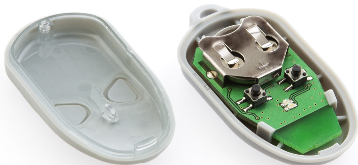
Рисунок 2. Идентификатор со снятой крышкой. Видна батарея питания
